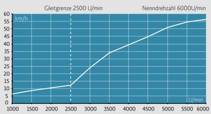
Leerlauf: 600 U/min, Höchstgeschwindigkeit: 56,6 km/h bei 6000 U/min. Gemessen mit GPS. 2 Personen an Bord. Treibstofftank halbvoll, windstill, keine Wellen.
