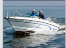
Dank des tief geschnittenen V-Rumpfes mit zwei Kimmkanten gleitet die kleine Griechin stabil. Sie schneidet Wellen - wegen Windmangels von uns selbst erzeugt – unerschüttert. Der Sitz ist bequem, mit gutem Überblick ist die respektable Höchstgeschwindigkeit von knapp 60 km/h schnell erreicht – das verlangt etwas Feingefühl beim Kurven fahren.
